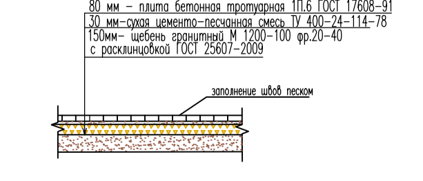
Проектируемое усиленное плиточное покрытие тротуаров
